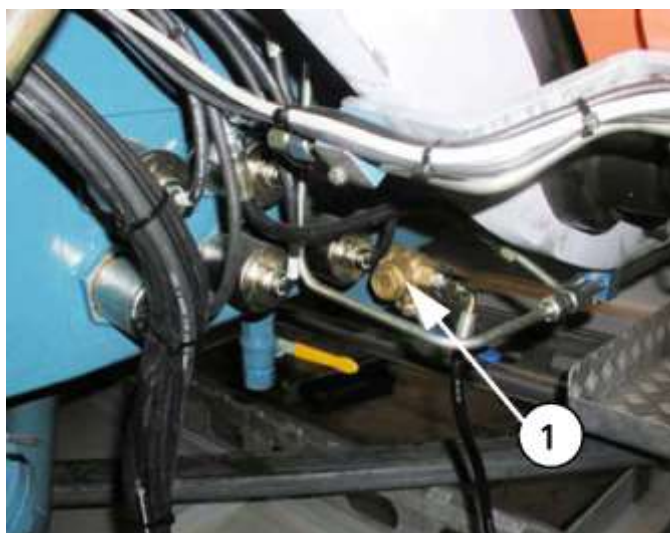
(1) 安装在变速箱中的球阀过滤器
