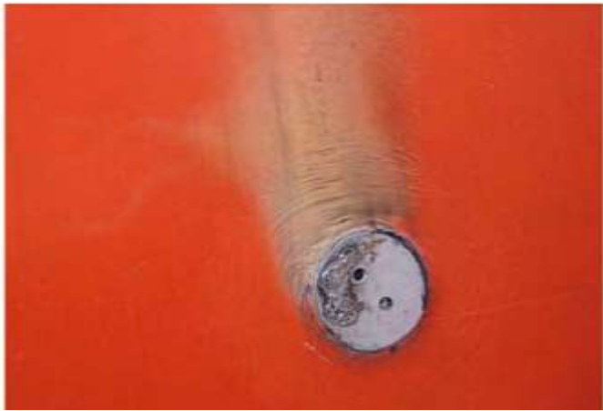
接闪器的熔化部位 无需修理或更换
