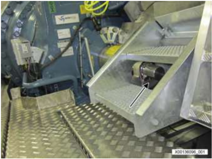
滑环 滑环在轮毂（旋转）中的控制柜和机舱中的非旋转部分之间传输功率和数据。
