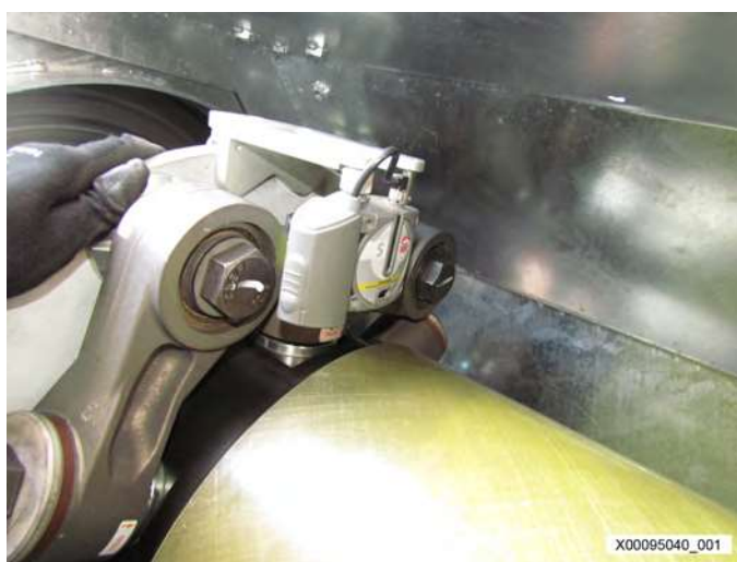
夹具激光头：变速箱侧，在激光头的正面标有字母“S”。
