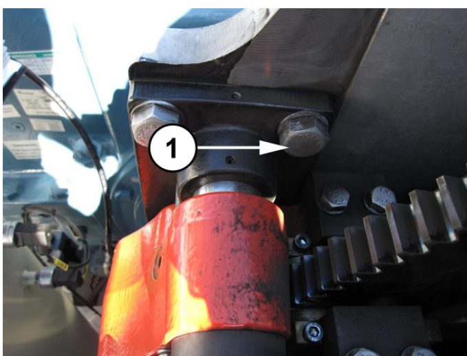
(1) N73 制动器卡钳 - 制动钳固定板
